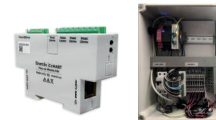
La **Placa de Medida CCMABT-D** lee todos los parámetros eléctricos de la línea de salida por cada una de sus fases, lo que permite al equipo la detección de eventos: caídas de tensión (instantáneas, mantenidas o huecos), sobretensiones (picos o subidas), flicker (duración breve o larga), error de frecuencia, armónicos, etc.
