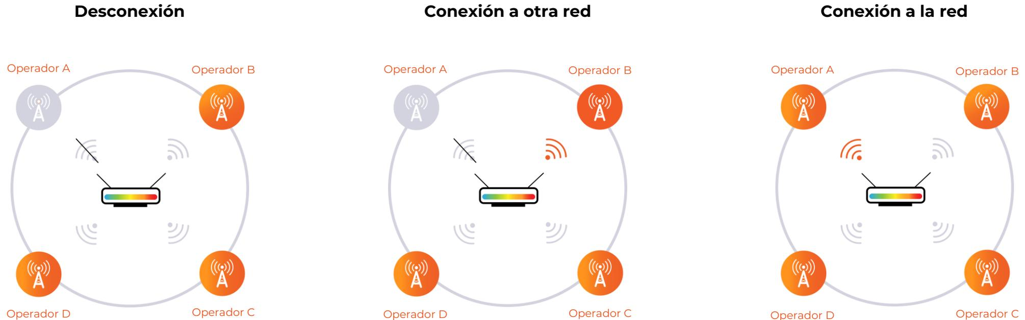
**Figura 1.** Esquema de desconexión y conexión de las tarjetas multioperadores EnerSIM Data y EnerSIM IP.
