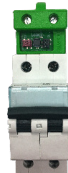
Figura 7: CcM2 instalado en magnetotérmico
