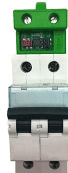
**Figura 7:** CcM2 instalado en magnetotérmico
