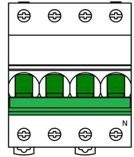
Figura 5: Interruptor magnetotérmico
