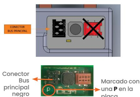
**Figura 12:** Crimpar conector para cable RS-485
