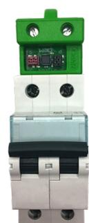
Figura 7: CcM2 instalado en magnetotérmico
