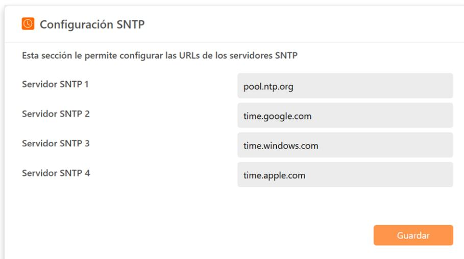
Figura 42: Web server – Configuración – Zona Horaria – SNTP
