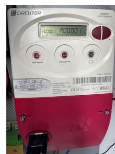
Figura 8 Conexión de cable DB9 en contador
