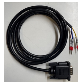
Figura 7 Cable DB9 macho acabado en conector
