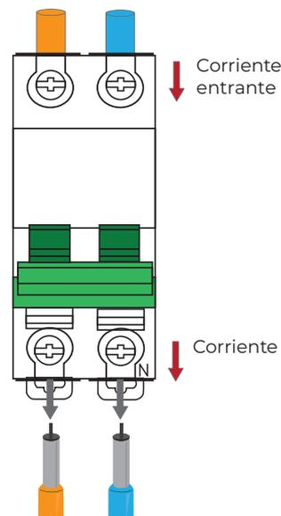
Figura 7 Desconexión de las líneas de corriente
