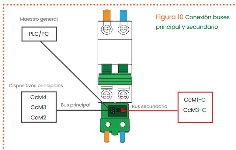
Figura 10 Conexión buses principal y secundario
