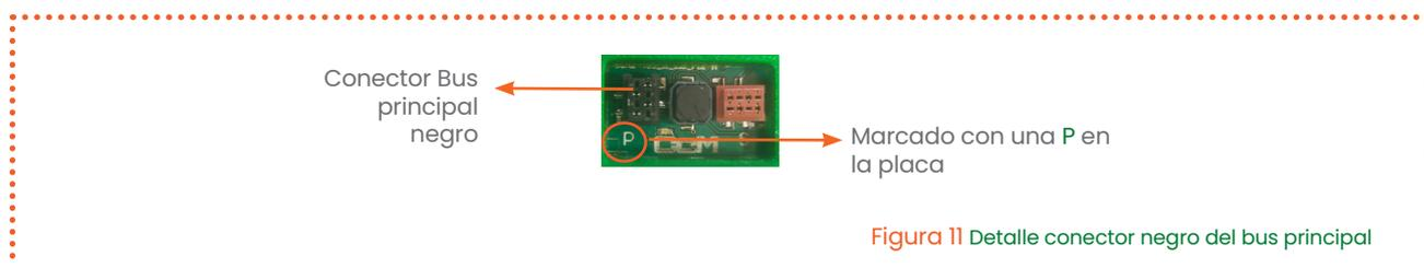
Figura 11 Detalle conector negro del bus principal
