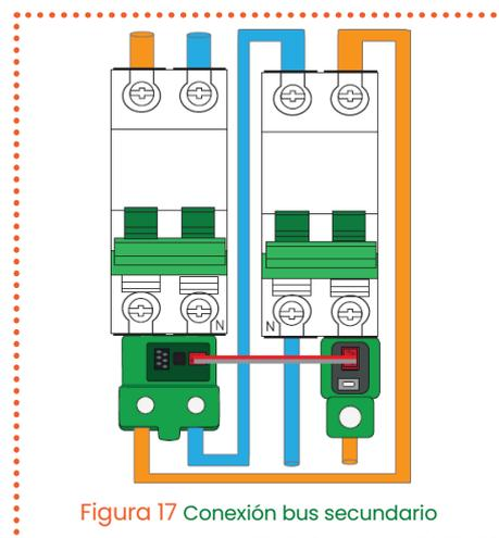
Tal y como se describió en el apartado 5.5.2, para crear un bus secundario se utilizará el conector rojo del CcM2 designado para este fin y se conectarán uno o varios dispositivos secundarios al mismo cable. Los dispositivos esclavos serán cM1-C o CcM3-C y se conectarán al interruptor diferencial/ magnetotérmico como se puede apreciar en la **Figura 17** (para más información, consulte el manual de instalación y configuración del dispositivo secundario en cuestión).
