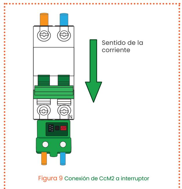
Figura 9 Conexión de CcM2 a interruptor
