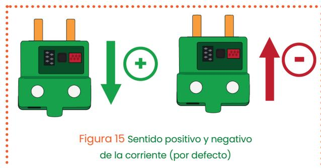
Figura 15 Sentido positivo y negativo de la corriente (por defecto)
