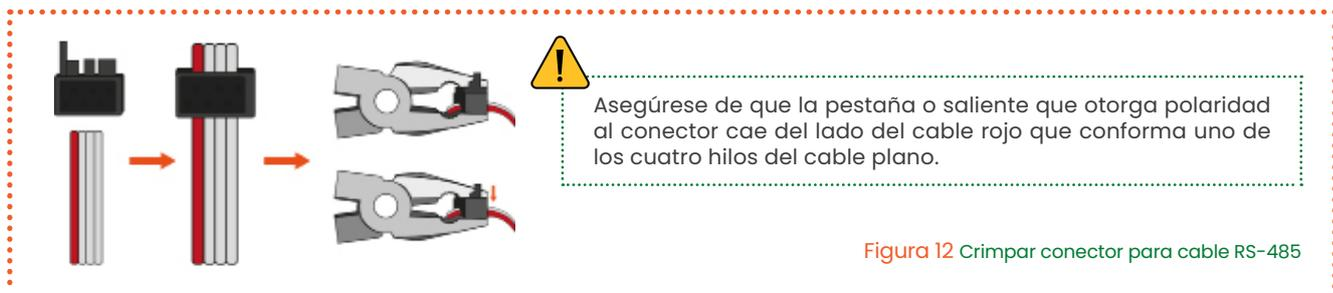
Se puede regular la distancia entre conectores para crimpar ajustándose a la distancia que se considere más adecuada para su instalación y/o distancia existente entre dispositivos conectados al mismo cable o bus.
