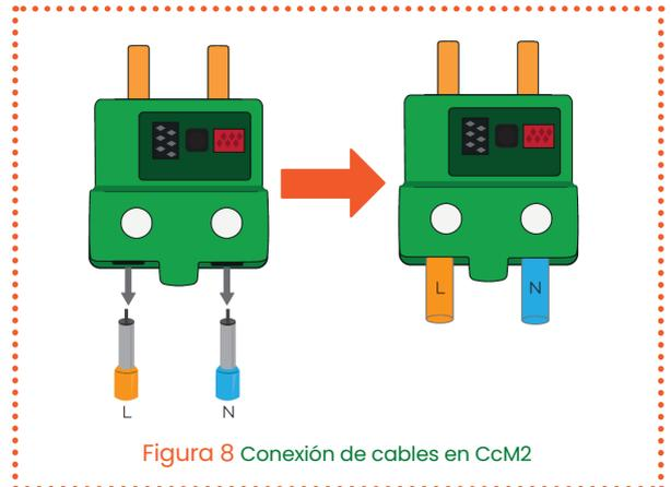
Figura 8 Conexión de cables en CcM2
