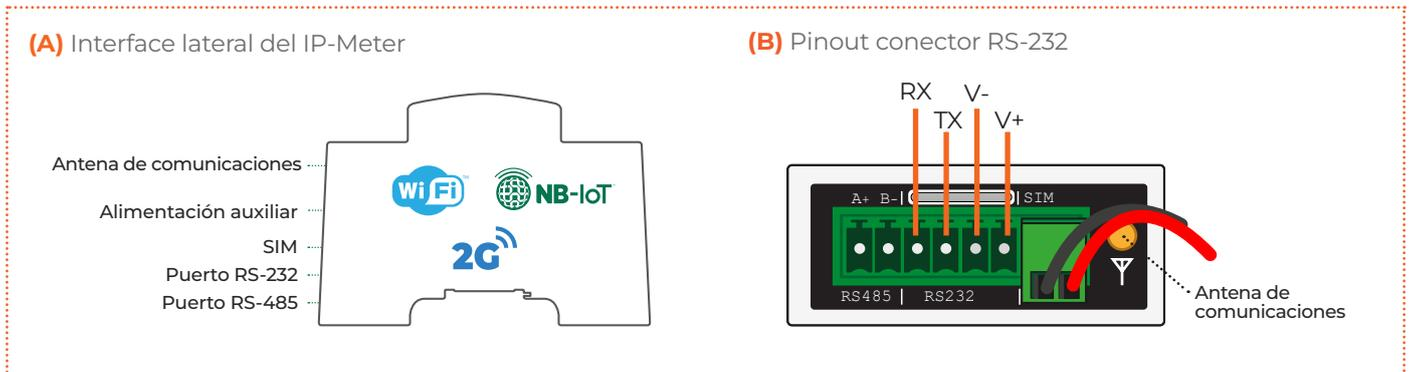
**Figura 3.** (A) Representación estructural de la interface lateral del dispositivo IP-Meter y (B) el pinout conector RS-232.
