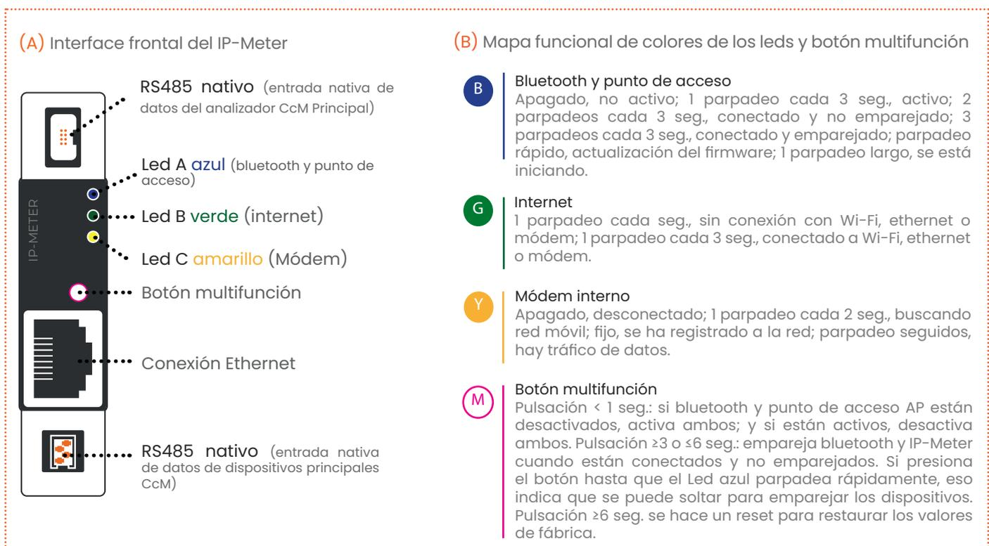
**Figura 2.** El dispositivo IP-Meter: **(A)** su interface frontal y **(B)** el mapa funcional de colores de los leds y del botón multifunción.
