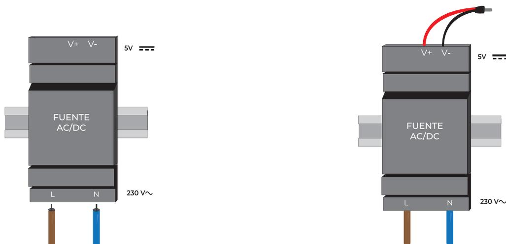
**1.1** Enclavar la fuente de alimentación AC/DC suministrada al carril DIN. Conectar la fase (L) y el neutro (N) a los puertos L y N de la fuente respectivamente. No olvidar que fase y neutro deberán estar correctamente protegidas.
