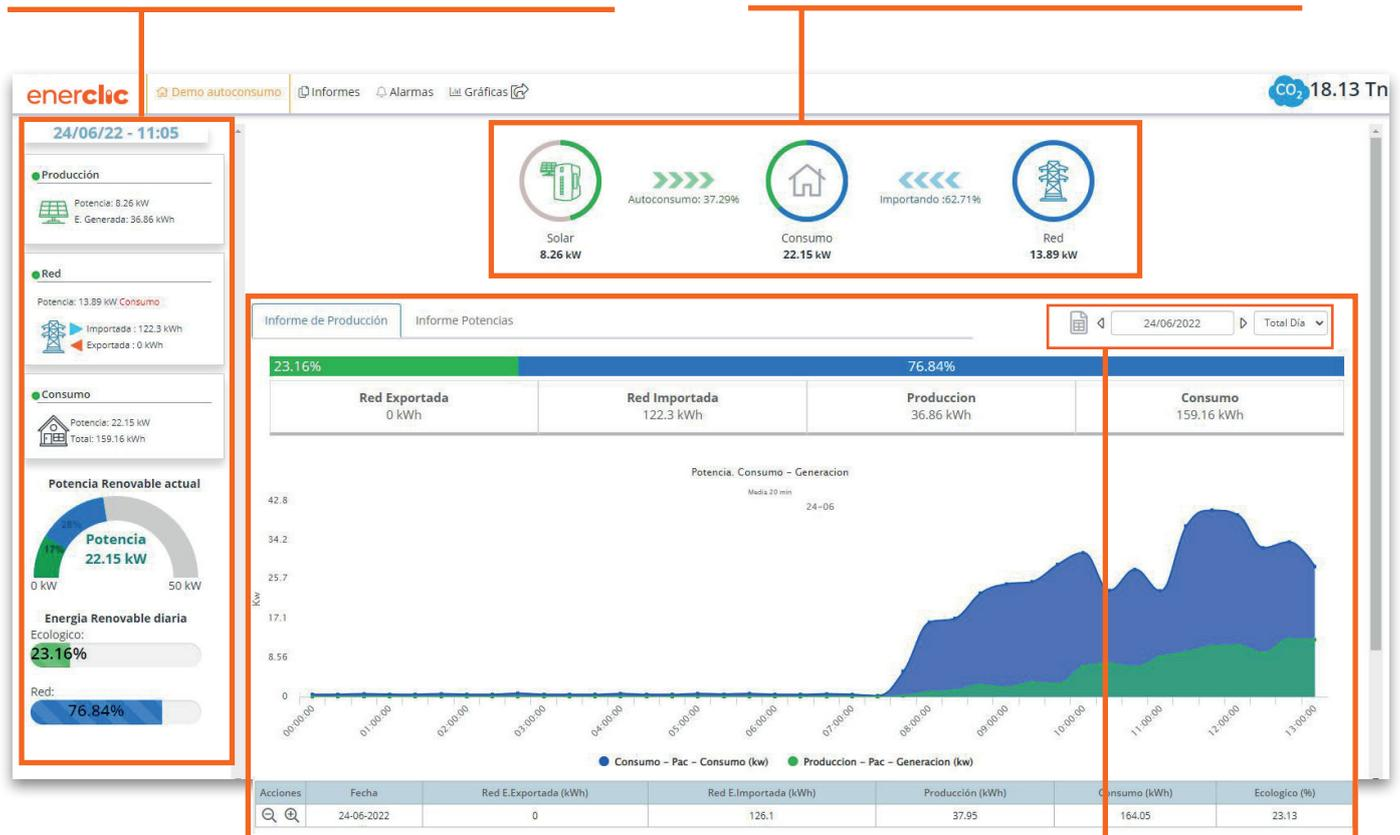
A continuación se muestra un diagrama que muestra el total de energía consumida tanto de red (azul) como del campo FV (verde) con su correspondiente gráfica que muestra en el intervalo horario la energía consumida y la generada. En la tabla de abajo se muestra el total diario y porcentaje ecológico.
