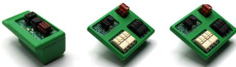
**Data loggers WiFi (CcM-WiFi, CcM-WiFi PT100 y CcM-WiFi On/Off):** Adquieren y envían los datos de un dispositivo principal y los envían a través de WiFi a un servidor o a otros dispositivos inteligentes (Smart loggers).
